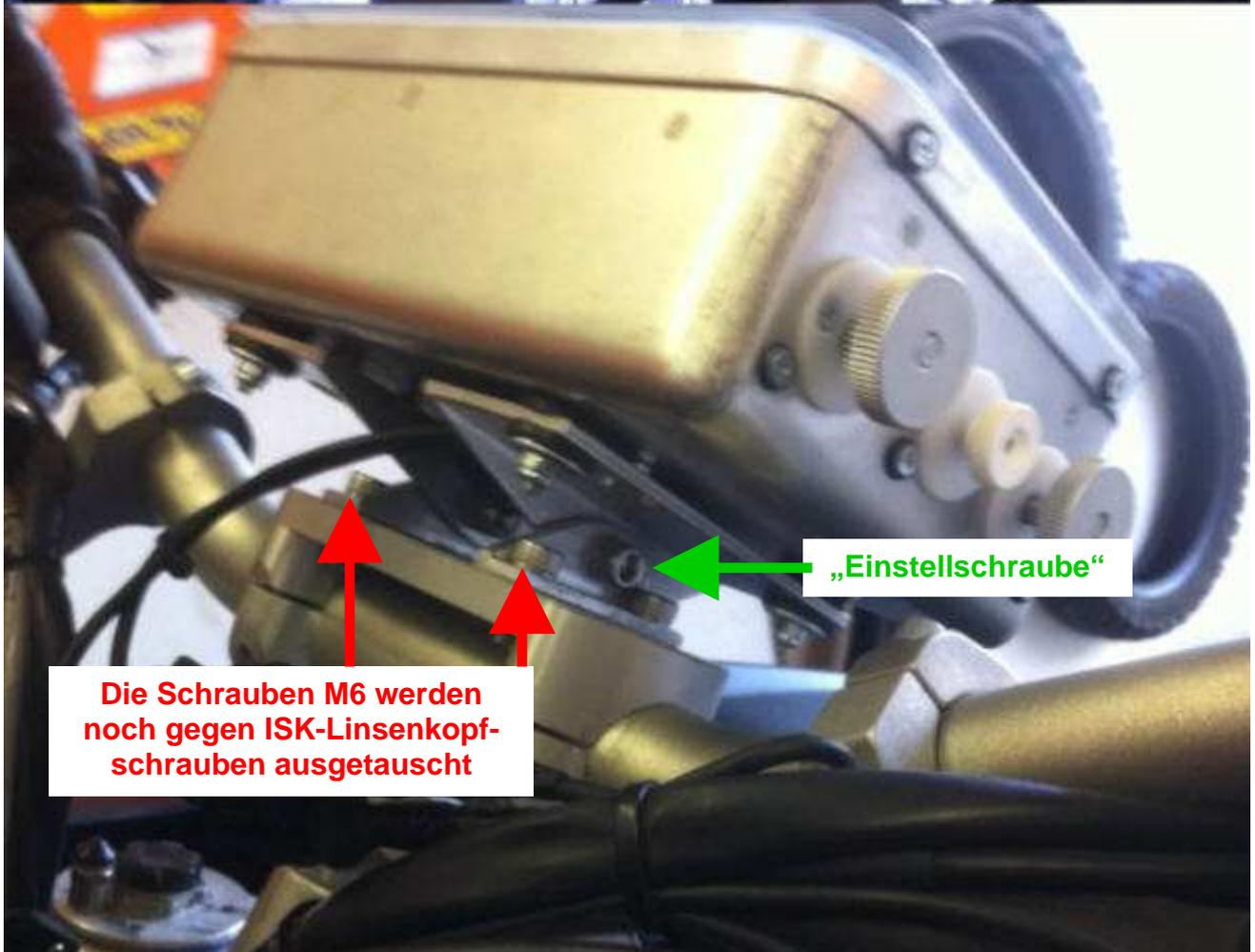
Die Schrauben M6 werden noch gegen ISK-Linsenkopfschrauben ausgetauscht
