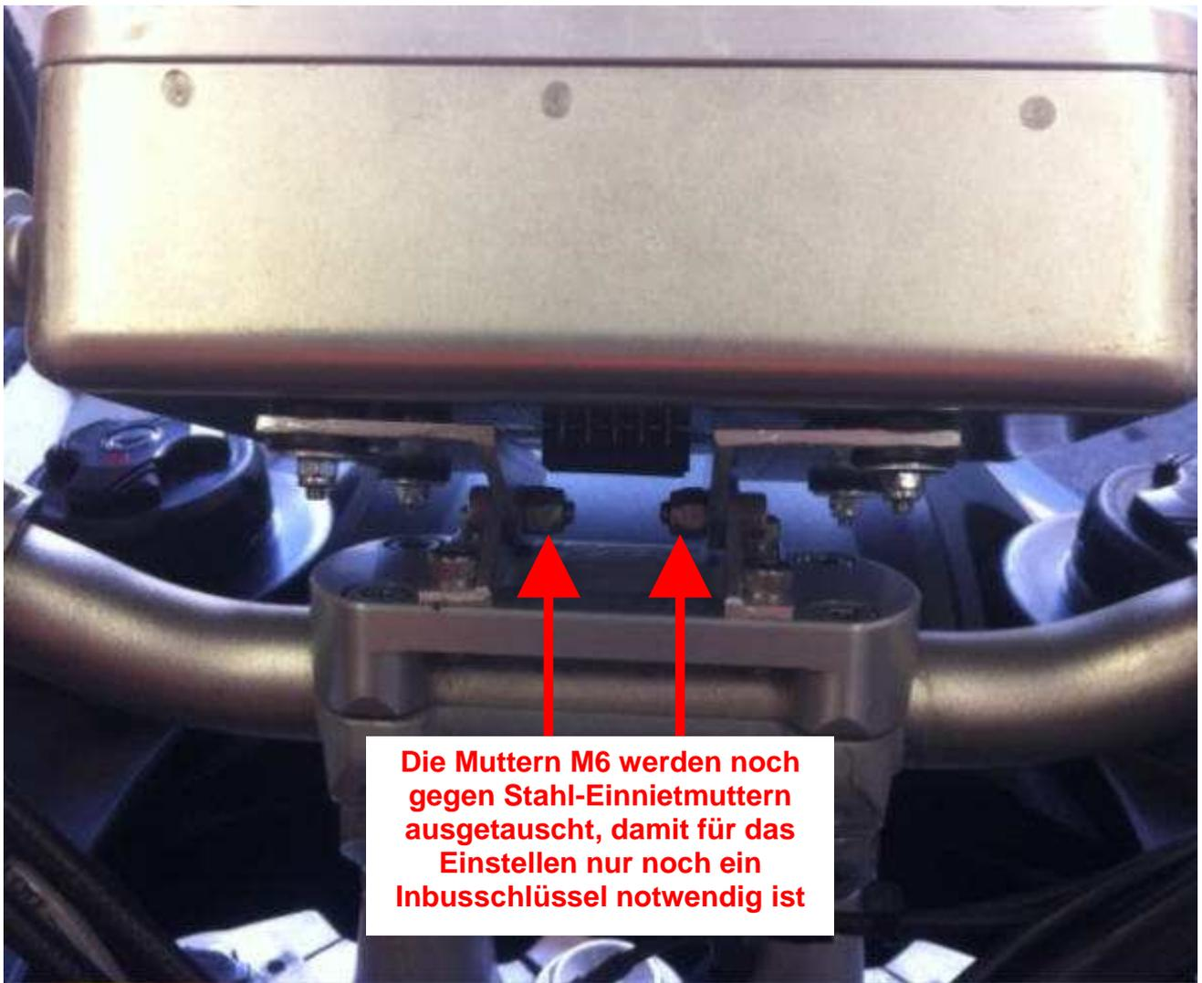
Die Muttern M6 werden noch gegen Stahl-Einnietmuttern ausgetauscht, damit für das Einstellen nur noch ein Inbusschlüssel notwendig ist
