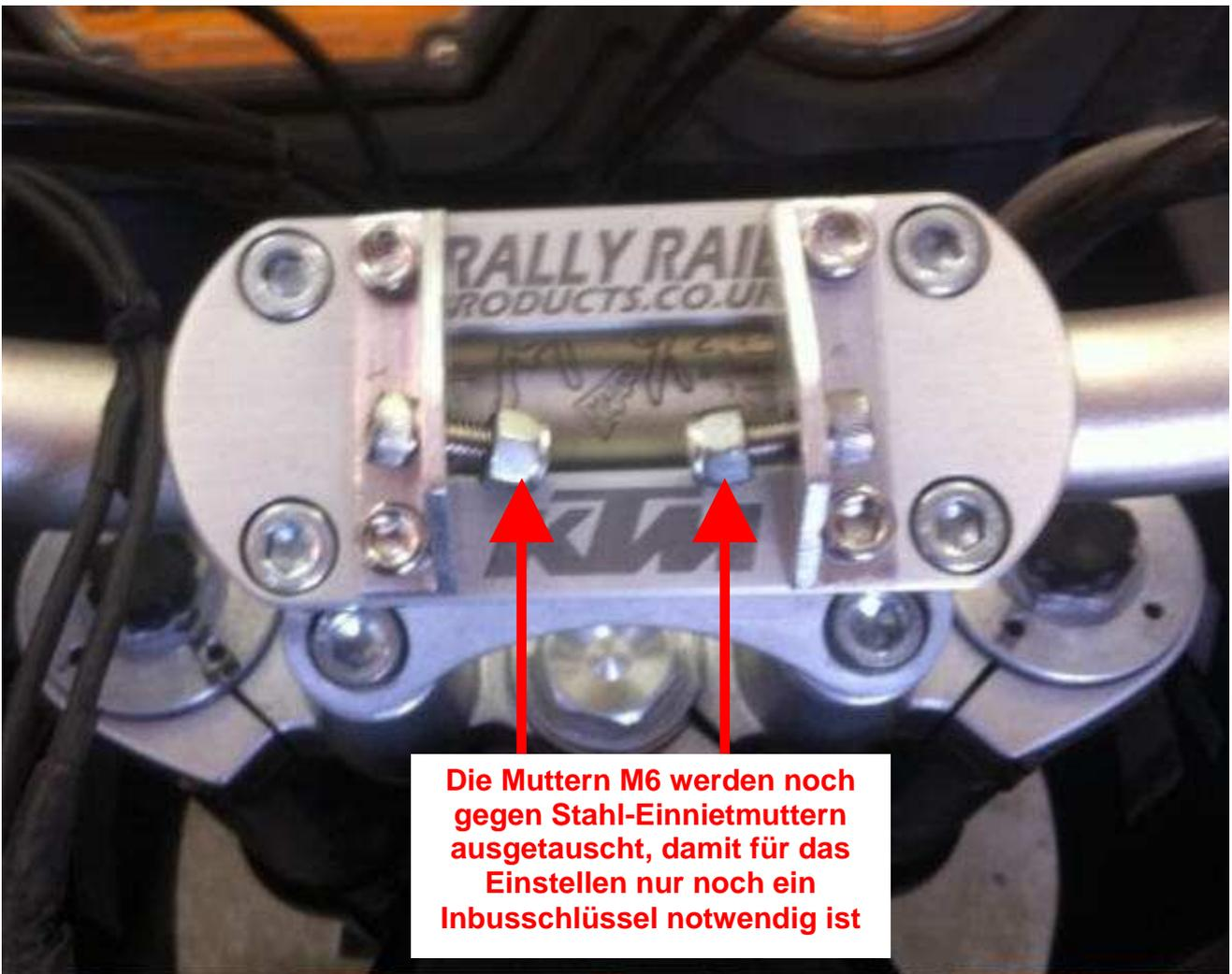
Die Muttern M6 werden noch gegen Stahl-Einnietmuttern ausgetauscht, damit für das Einstellen nur noch ein Inbusschlüssel notwendig ist
