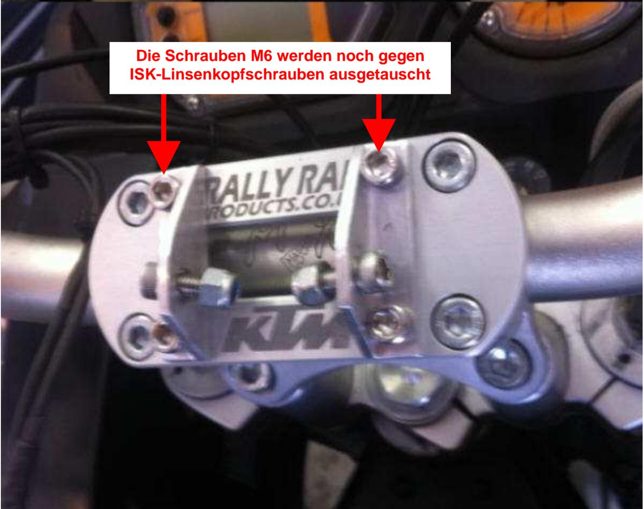
Die Schrauben M6 werden noch gegen ISK-Linsenkopfschrauben ausgetauscht
