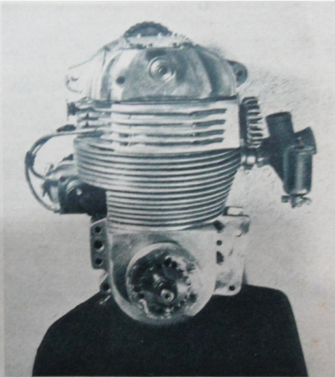
Ansicht auf die linke Seite des Prototyps des Maneschl-Parallel-Zweizylindermotors, der zwei obenliegende Nockenwellen besitzt
