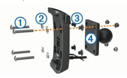
2 Ziehen Sie die Muttern an, damit die Basisplatte sicher befestigt ist.
