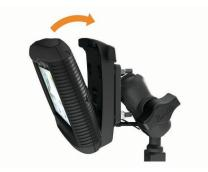
2 Drücken Sie das Gerät zurück, bis es einrastet. HINWEIS: Wenn die Verriegelung oben an der Halterung nach dem Einsetzen des Geräts nicht flach ist, drücken Sie sie nach unten.
