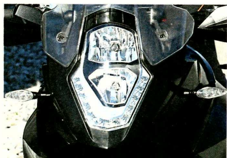
Neues Gesicht: Doppelscheinwerfer mit Tagfahrlicht in LED-Technik, schlanke Blinker
