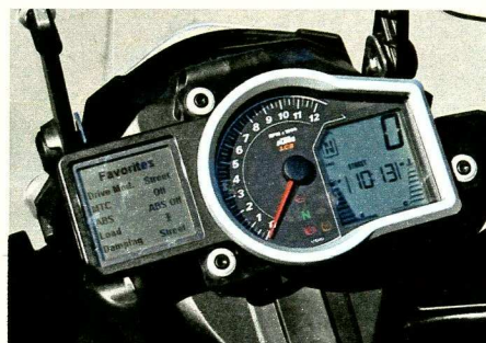
Das neue Cockpit informiert mit analogem Drehzahlmesser und zwei Displays
