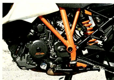
V2-Kraftpaket, sauber verarbeiteter Stahlrohrrahmen, Öltank mit Schauglas
