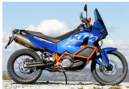
Die Form der ersten Adventure von 2003 (links oben) war überwiegend von den technischen Gegebenheiten eines Rallyemotorrads bestimmt. Daran hat sich bis zur heutigen R-Variante (links unten) wenig geändert. Beim neuen Modell ist die Seitenansicht stärker strukturiert, so wirkt sie optisch leichter. Allenthalben wenden sich die Konstrukteure von der Unterseat-Anordnung der Schalldämpfer ab, KTM macht da bei der Adventure und der Super Duke keine Ausnahme
