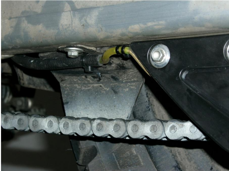
Hinten auf die „Kunststofffinne“ habe ich mit Silikon ein Messingrohr geklebt. (das Foto zeigt die einbaufertige Finne von hinten)
