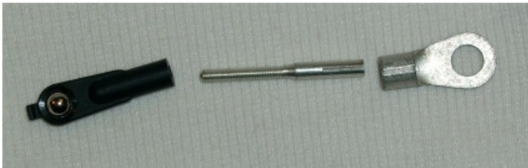
Die Löthülse wird in die Anschlußöse eingelötet und der Kugelkopf wird aufgeschraubt (mindestens so 5-6 Umdrehungen siehe Foto; hier noch nicht verlötet)
