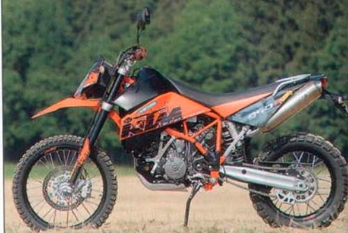
**MOTOR** flüssigkeitsgekühlter Zweizylinder-Viertaktmotor, V-Anordnung, je zwei kettengetriebene obenliegende Nockenwellen, je vier Ventile
