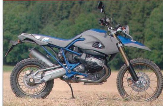
**MOTOR** luft-/ölgelühlter Zweizylinder-Viertaktmotor, Boxeranordnung, je zwei hochliegende kettengetriebene Nockenwellen, je vier Ventile, Doppelzündung
