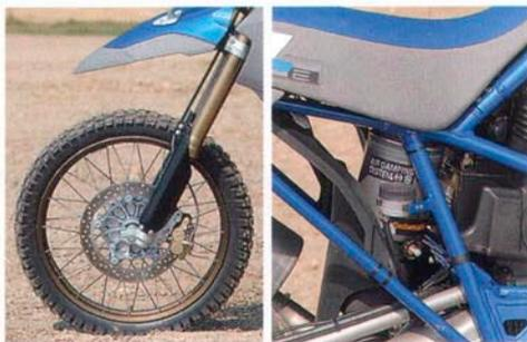
Die Federelemente der HP2 gefallen durch sensibles Ansprechverhalten und gute Traktion, sind im harten Geländeeinsatz jedoch überfordert.
